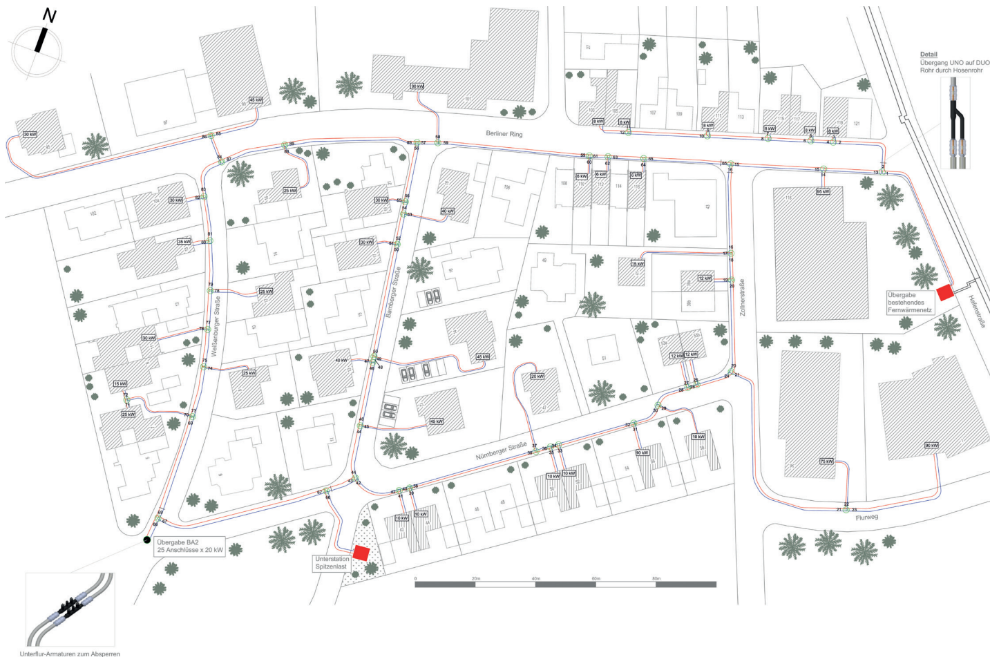
Rysunek 3: Sieć ciepłownicza w dzielnicach z dwoma węzłami ciepłowniczymi i zazębieniem (Źródło: REHAU)
